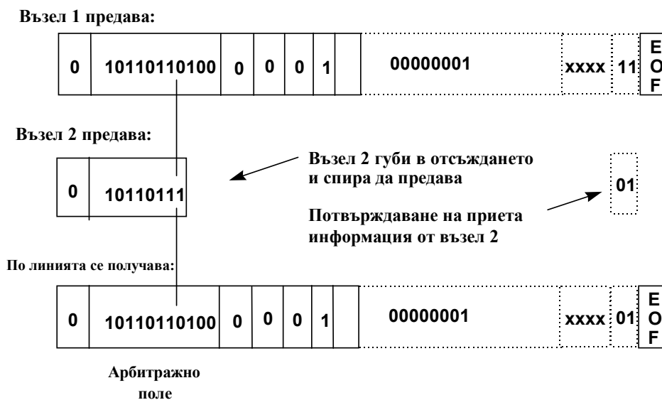
Фиг. 2.3.4. Арбитражиране на достъпа до средата в CAN мрежа
