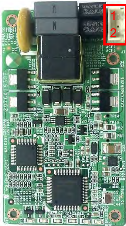
PLC module top side
